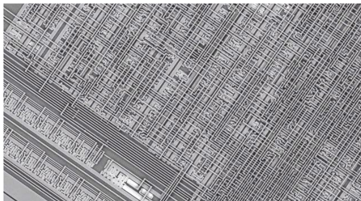
Figure 2 : Image au microscope électronique d'un niveau d'interconnexions métalliques.
