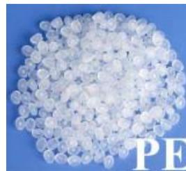
Figure 2.1 : Photographie des granules de Polyéthylène basse densité.
