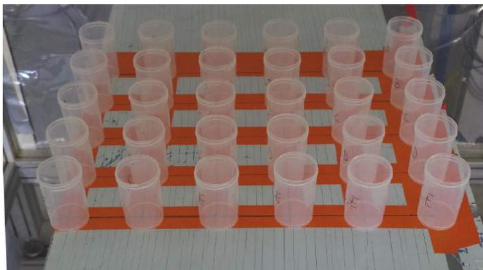
FIGURE III.5 – Système permettant la mesure des précipitations appliquées sur le modèle. Après chaque session de test (10 min), la hauteur d'eau est mesurée dans chacun des béchers.
