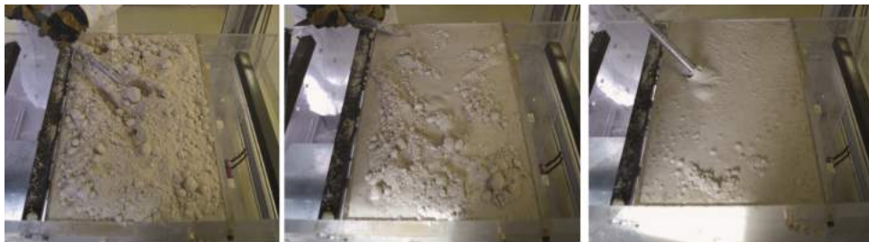
FIGURE III.13 – Etapes successives de l'homogénéisation de la pâte de silice avant une modélisation. Sur la première image on peut observer le résultat obtenu après le mélange préliminaire de la poudre de silice et l'eau. Sur la seconde et la troisième image on peut voir le résultat de l'homogénéisation. On obtient une pâte totalement lisse en fin d'homogénéisation.
