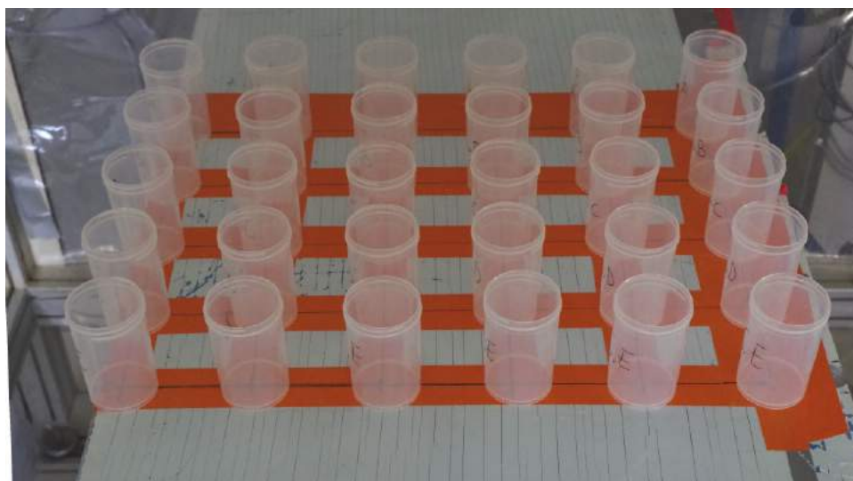
FIGURE III.5 – Système permettant la mesure des précipitations appliquées sur le modèle. Après chaque session de test (10 min), la hauteur d'eau est mesurée dans chacun des béchers.
