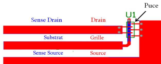
*Fig. 44. Dessin du schéma de conception du PCB*
