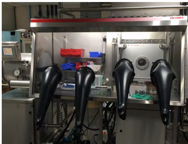
FIGURE 3.9 – Photographie de la boîte à gants contenant le bâti d'évaporation.
