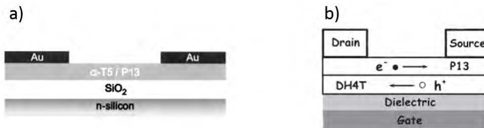
FIGURE 1.27 – a) Représentation schématique d'un OLET comportant un mélange de PTCDI-C 13 H 27 et de \alpha -T5 [51]. b) Représentation schématique d'un OLET bicouche. [53]
