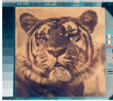
FIGURE 2.14 – Image d'un écran 64 x 64 à matrice active composé de 4096 transistors organiques pour allumer chaque pixel. [85]
