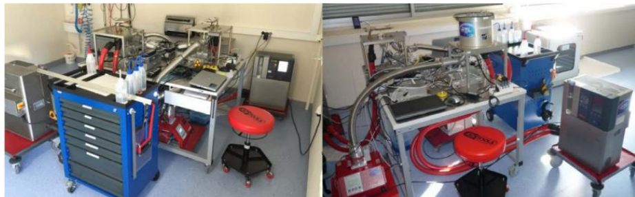
FIGURE 4.1 – Photographie des deux bancs de tests utilisés pour les tests de performances des modules XRDPIX unitaires.
