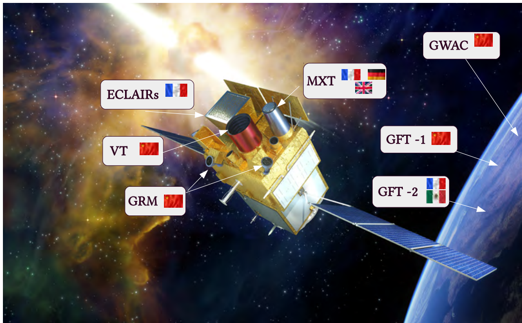
FIGURE 1.12 – Répartition des différents instruments embarqués à bord de la plateforme SVOM et des télescopes de la composante sol du projet. Les drapeaux indiquent les contributions principales des pays associés au projet.
