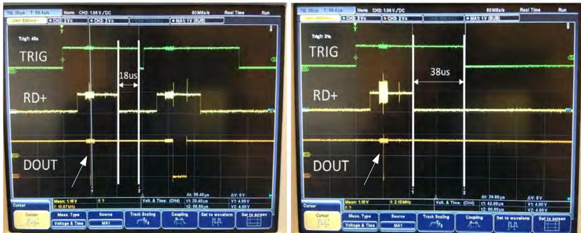
FIGURE 3.14 – Signaux TRIG, READ(+) et DOUT d'un module pour les cas à gauche où une perturbation du signal DOUT entraîne une retombée du TRIG 18 \mu\text{s} après la retombée du READ au lieu de 36 \mu\text{s} . Les flèches blanches représentent la perturbation du signal (glitch). À droite, la vue d'oscilloscope présente les signaux obtenus après à la modification de l'échantillonnage et la modification de la position de la résistance. Le signal TRIG retombe après le délai du RSM suite à la retombée du READ, comme cela est attendu.
