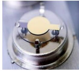
Figure I.7. Résonateur à ondes acoustiques de volume de type plaque.
