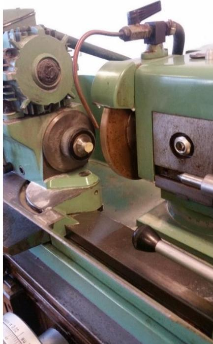
Figure II.6. Rectification cylindrique de la lame.
