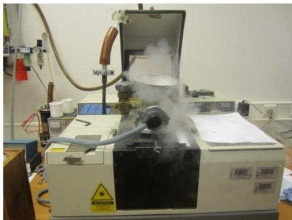
Figure II.24. Spectromètre infrarouge à transformée de Fourier ; analyse à température de l'azote liquide
