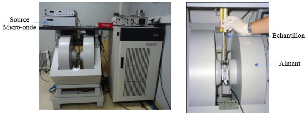
Figure II.27. Spectromètre RPE Bruker ER100.
