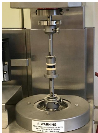
Figure 3-11 Rhéomètre rotatif AR 200 à déformation imposée. Un fantôme à base de plastisol est placé entre les deux disques.
