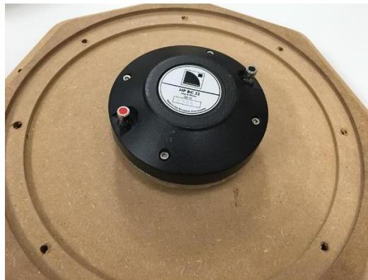
Figure 2-7 Haut-parleur HP BC 22: bande de fréquence de 0,5-20 kHz, puissance de 1500 W. Le moteur de compression comporte à sa fabrication un embout afin d'y insérer un pavillon.
