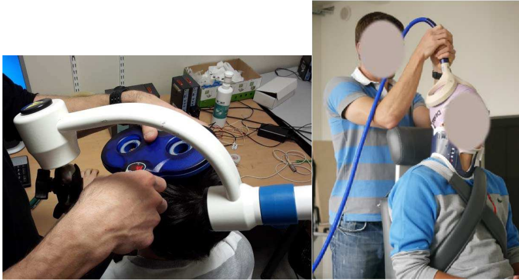
Figure 22: A gauche, positionnement de la bobine en forme de huit lors de la stimulation magnétique transcrânienne effectuée sur le muscle court abducteur du pouce. A droite, placement de la bobine en cône pour la stimulation des muscles extenseurs du genou
