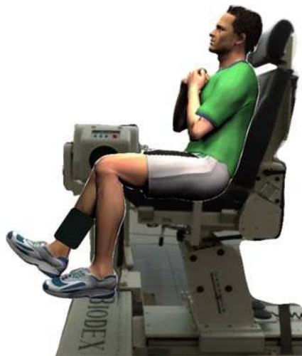
Figure 18: Représentation du placement d'un sujet sur l'ergomètre isocinétique Biodex
