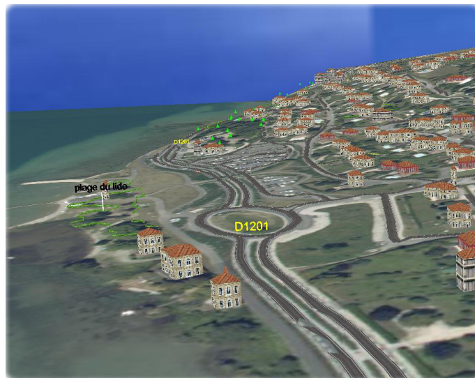
FIGURE 99 – Placage 3D de dalles d'orthophoto sur un terrain, Source : projet SIG4D, promo IASIG 2012
