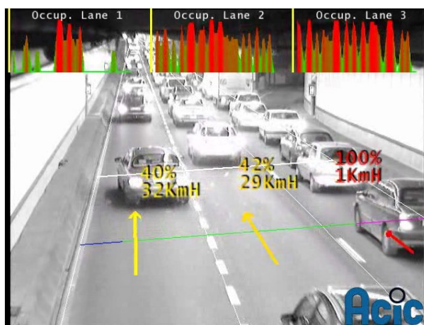
FIGURE 98 – Détection de la vitesse des véhicules par caméra
