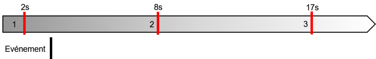
FIGURE 51 – Principe de l'évolution par événement dans la simulation discrète
