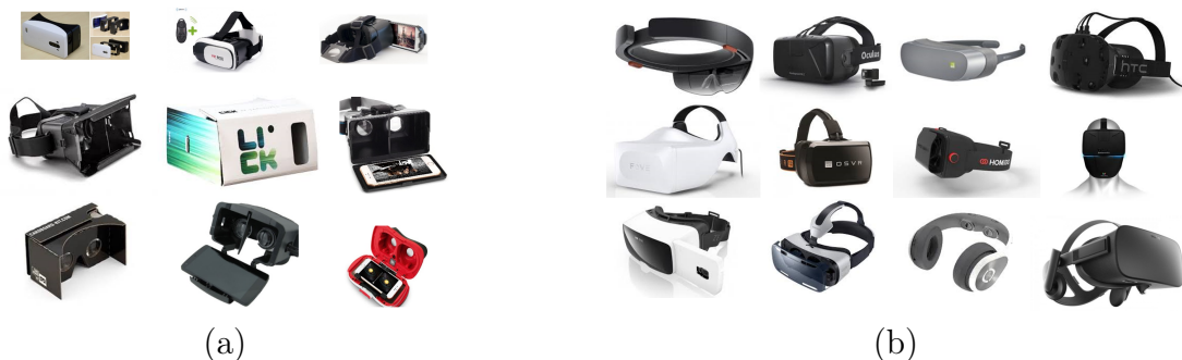
FIGURE 93 – Exemples de casques de Réalité Virtuelle sans écran intégré (a) ou avec écran intégré (b)
