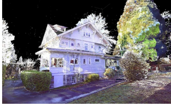
FIGURE 28 – Représentation d'une capture 3D par Lidar d'une façade de maison
