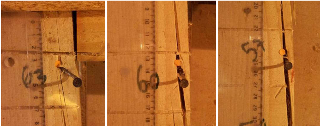
Figure III-54. Déformation des clous sollicités perpendiculairement aux sens des fibres du bois.
