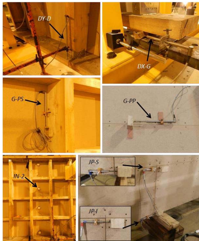
Figure III-19. Mise en place des capteurs de déplacements et des inclinomètres.
