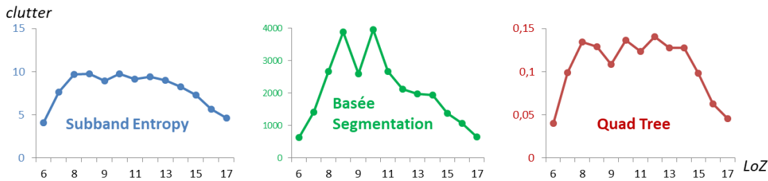
Figure 57. Évolution des valeurs de clutter pour les trois mesures utilisées, en fonction du niveau de zoom correspondant (LoZ), pour la pyramide Scan Express de l'IGN.
