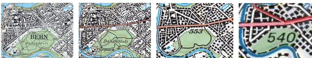
Figure 101. Utilisation d'un processus de typification à plusieurs échelles consécutives dans la pyramide cartographique de Swisstopo.
