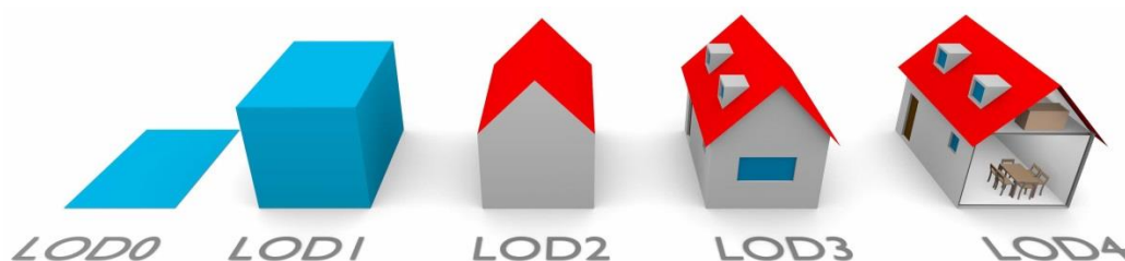
Figure 11. Illustration des 5 gammes de niveaux de détail définies pour le format standard CityGML [OGC 2012]. Source de l'image : TUDelft.
