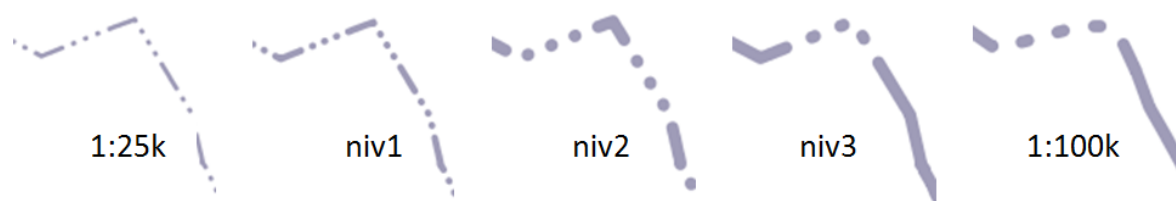
Figure 88. Variation de la symbolisation des limites administratives de communes, vues à même échelle ici.
