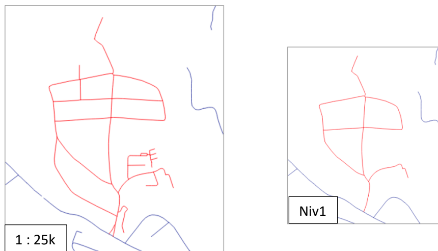
Figure 93. Illustration d'un groupe d'impasses présentant des cycles et devant encore être traité manuellement (en rouge).
