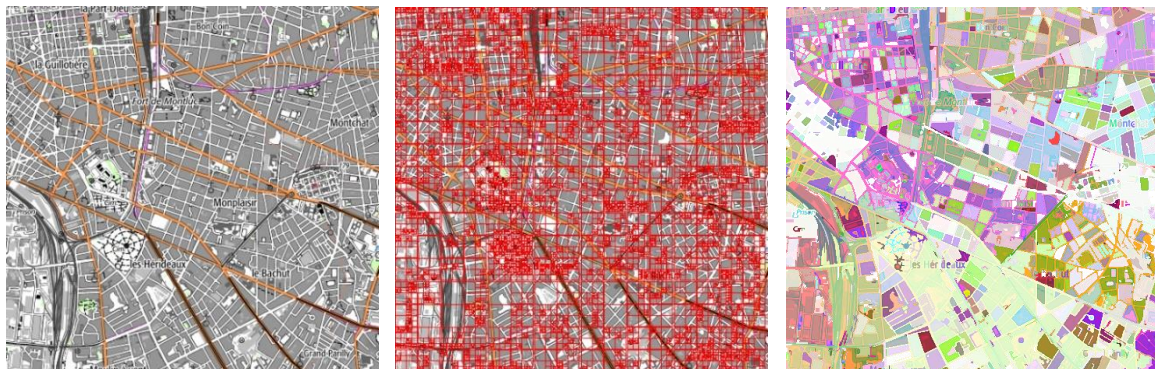
Figure 58. Représentation des résultats graphiques des mesures de clutter dans l'image de gauche extraite de la pyramide Scan IGN, respectivement avec les mesures dite par quadtree (au milieu) et basée segmentation (à droite).
