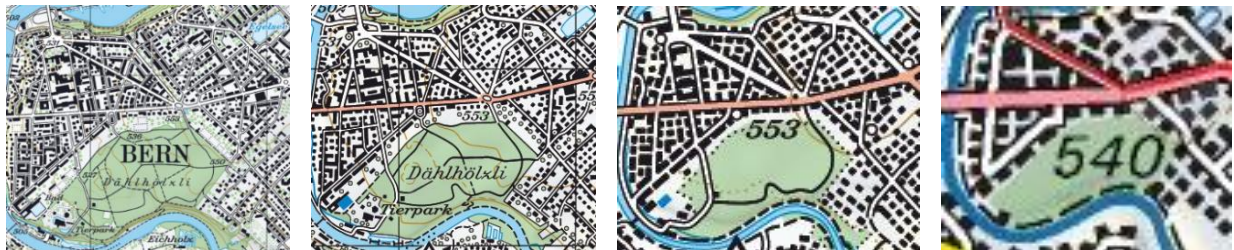
Figure 50. Conservation des structures spatiales par utilisation d'un algorithme de typification du bâti, dans quatre niveaux de zoom consécutifs. Extraits : Swisstopo.
