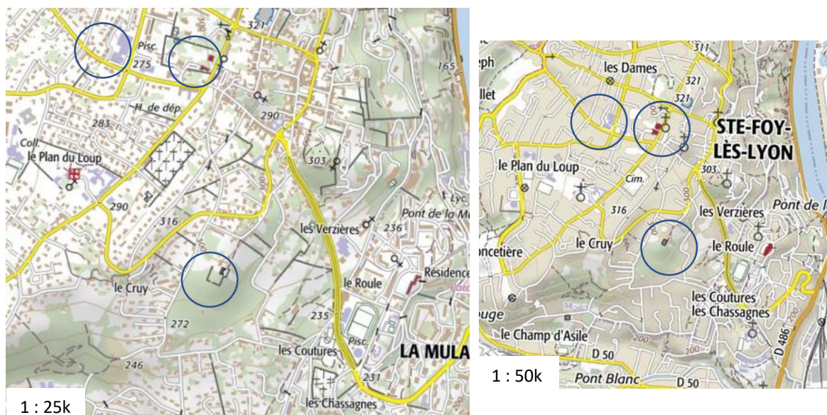
Figure 119. Préservation d'une représentation détaillée des bâtiments spéciaux (en rouge, violet, gris) au-dessus des îlots urbains dans la carte au 1 : 50k de la pyramide Scan Express. Si la géométrie de ces bâtiments est grossie, elle n'est pas simplifiée et présente parfois des problèmes de lisibilité à petite échelle.
