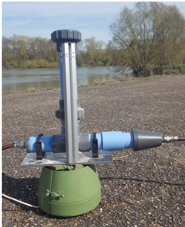
FIGURE 2.22: Ensemenceur utilisé pour les essais PIV
