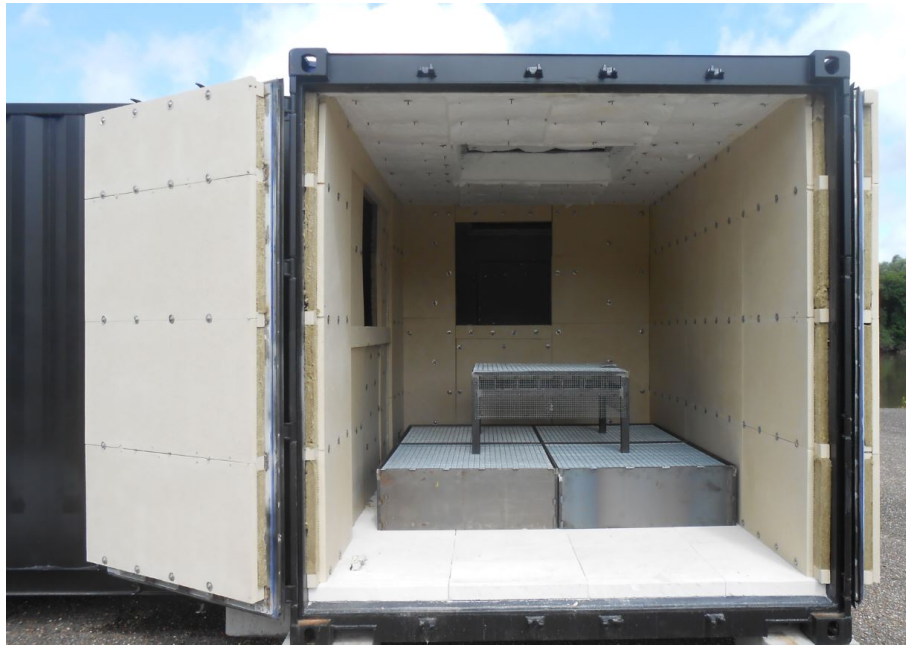
FIGURE 2.4: Isolation de la cellule d'essais
