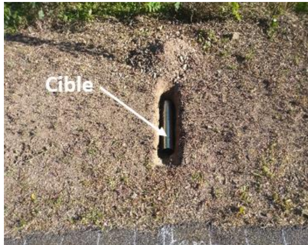
Fig. III-82. Cible enterrée à une profondeur de 12 cm
