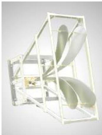
Fig. I-33. Antenne Libellule (à gauche) et son module du paramètre S_{11} (à droite)
