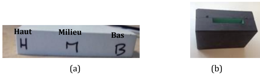
Fig. II-28. Schéma des zones cartographiées de l'échantillon [(Si_{1.2}KOH^{12}M1Z_{13.2})^{20}70] (a) coulé dans un moule dont les dimensions sont (8*8*1.2 cm) (b)
