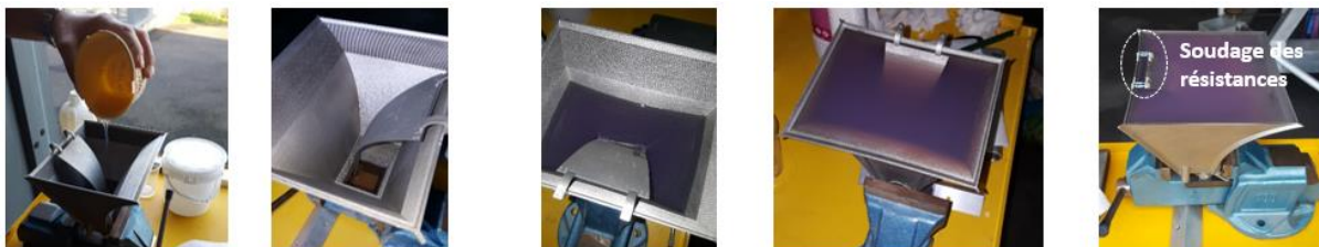
Fig. III-57. Protocole de remplissage de l'antenne ACD
