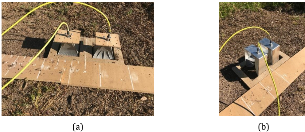
Fig. III-85. Antenne ACD résine en émission et ACD géopolymère en réception (a) deux antennes K l'une pour l'émission et l'autre pour le réception
