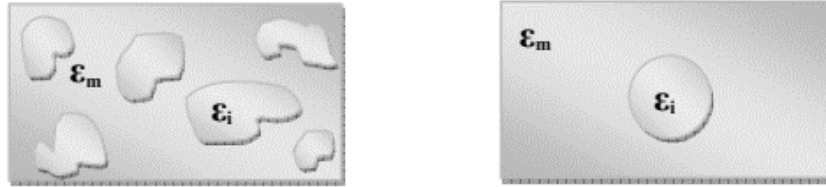
Fig. II-20. Milieu modélisé par la théorie de Maxwell Garnett dont toutes les inclusions sont ramenées à une inclusion unique
