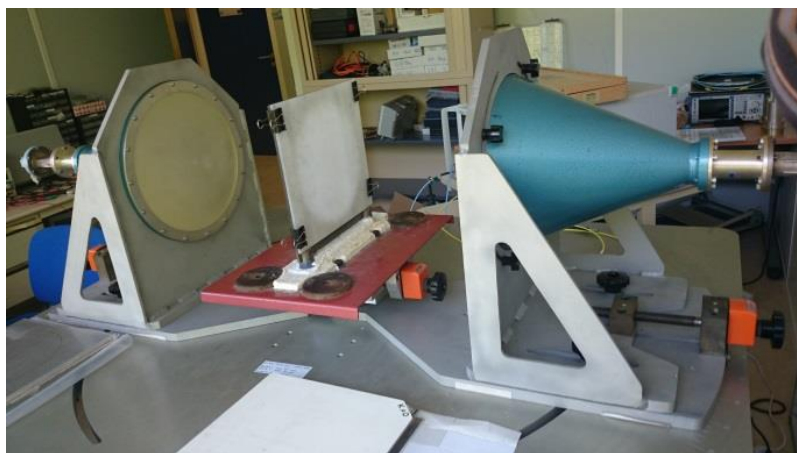
Fig. II-10. Exemple d'un banc de caractérisation en espace libre focalisé développé par XLIM [13]
