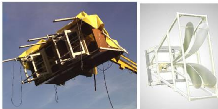
Fig. I-14. Antenne ciseau (à gauche) et Antenne libellule (à droite) intégrées sur le radar de détection de mines PULSAR
