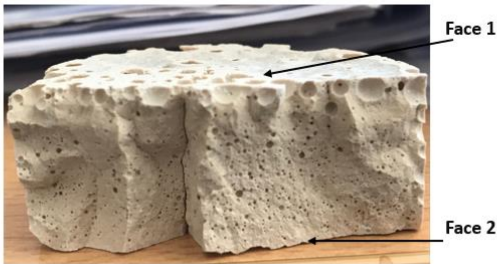
Fig. II-44. Vue en coupe mettant en évidence la répartition de la porosité de l'échantillon [2/3( \text{sc KOH}^{12}\text{M1}_{\text{Al } 0.1} ) + 1/3 ( \text{sl KOH}^{12}\text{M1}_{\text{Al } 0.1} )]
