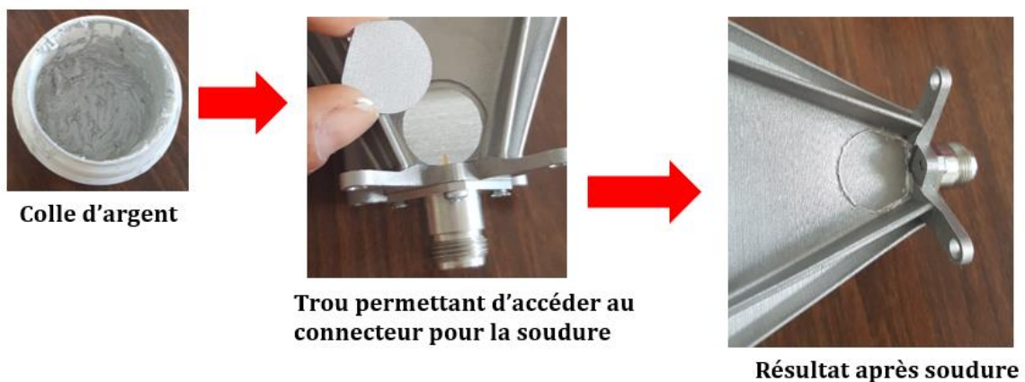
Fig. III-54. Protocole de soudure du connecteur de l'antenne
