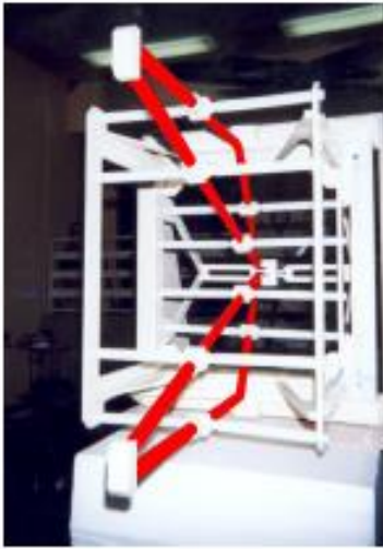
Fig. I-34. Antenne Ciseaux (à gauche) et son module du paramètre S11 (à droite)
