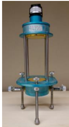
Fig. II-14. Résonateur ouvert fonctionnant de 55 à 110 GHz développé par AB millimètre [21]
