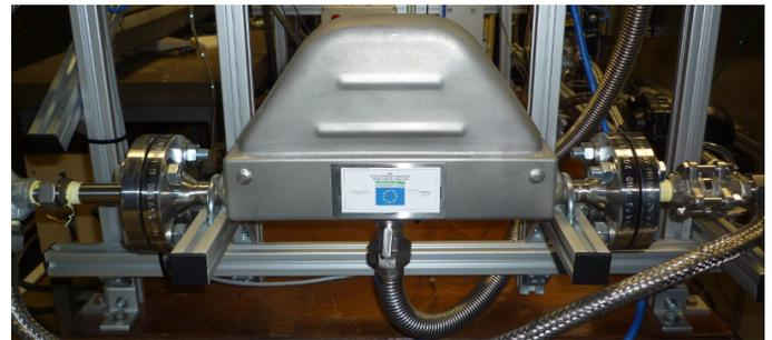
Figure 3.27 : Débitmètre utilisé pour la vapeur
