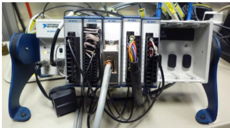
Figure 3.33 : Centrale d'acquisition
