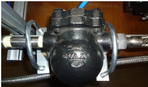
Figure 3.26 : Purgeur à flotteur
