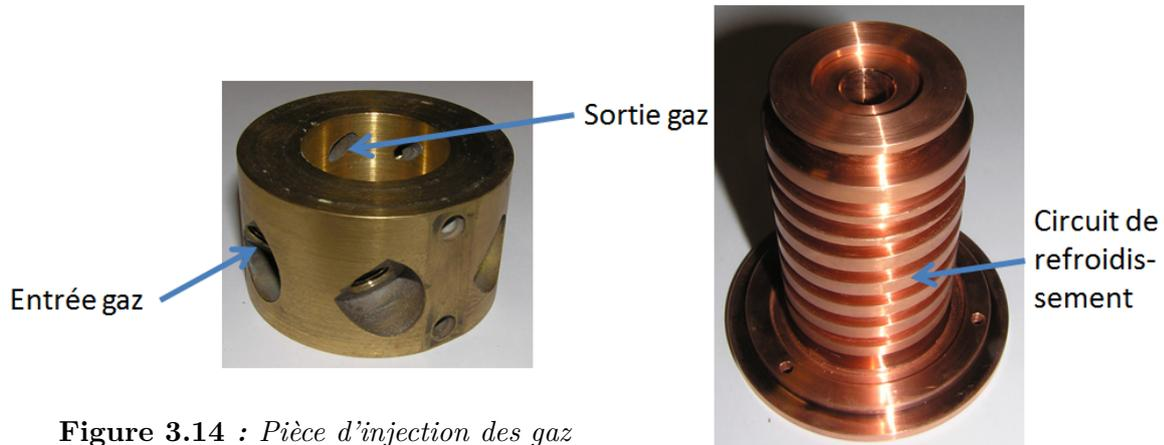
Figure 3.14 : Pièce d'injection des gaz
