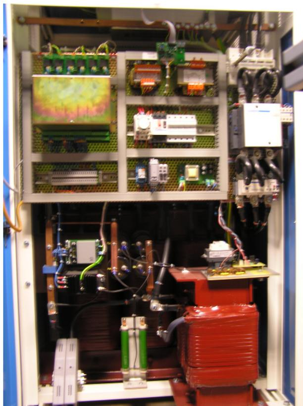
**Figure 3.16** : Alimentation électrique de la torche à arc non transféré du LAEPT
