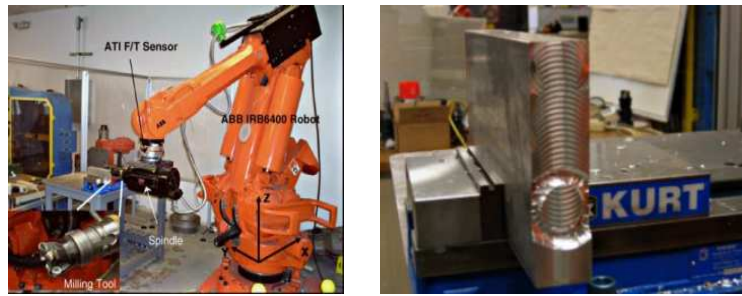
Figure 1-9 : Marquage important de la pièce dû aux vibrations du manipulateur [Pan et al. 2006]
