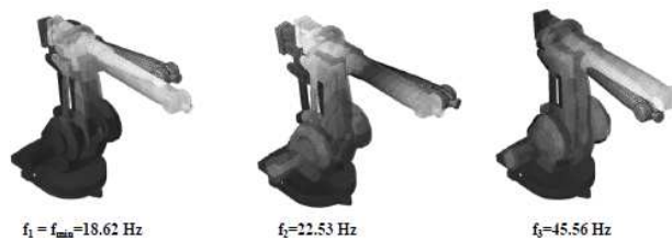
Figure 1-8 : Analyse numérique des modes vibratoires d'un manipulateur [Karagulle et al. 2012]
