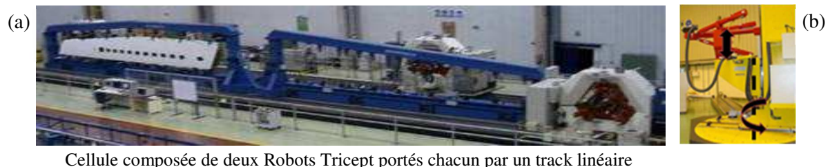
Figure 1-18 : Fraisage robotisé sur gouverne d'avion (a), cellule robotisée à 8 ddls (b)
