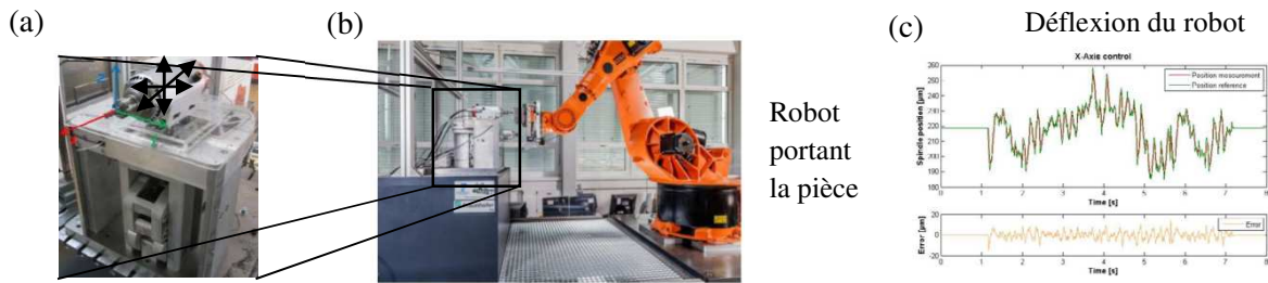
Figure 1-19 : Système piezo à 3 ddls portant la broche (a), cellule d'usinage (b), déplacement de la broche suivant l'axe X et erreurs de précision obtenues (c) [Schneider et al. 2013]
