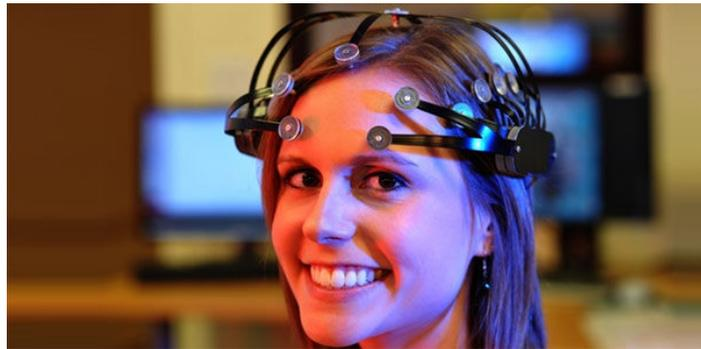
FIGURE 1.9 – Capteur sans fil EEG à 14 canaux proposé par EMOTIV Epoc+.
