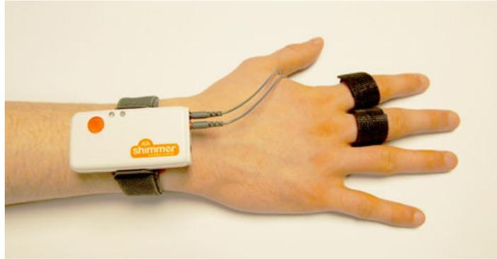
FIGURE 1.8 – Capteur GSR sans fil fourni par Shimmer. Il permet de mesurer les caractéristiques électrique ou la conductance de la peau.
