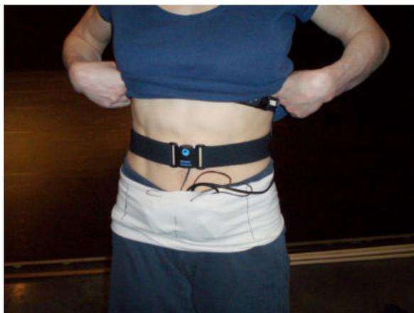
FIGURE 1.12 – Capteur mobile de respiration permettant de capter la respiration ventrale ainsi que thoracique [Baud and Sèdes, 2009].
