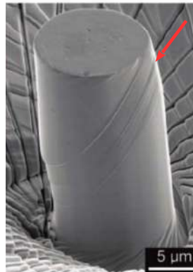
Figure 1.11 – Image MEB d'un nanopilier de Ni de 10\ \mu\text{m} de diamètre après la compression. La flèche pointe les marches laissées en surface par les dislocations échappées. [Uchic et al. , 2004].
