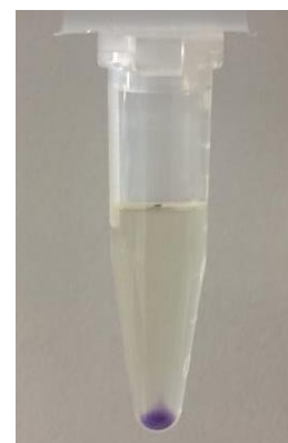
Figure 2.7 : Schéma de la réaction entre une chaîne de polystyrène chlorométhylée et la NBP ; image des particules chlorométhylées devenues violettes après traitement à la NBP (après centrifugation des particules).
