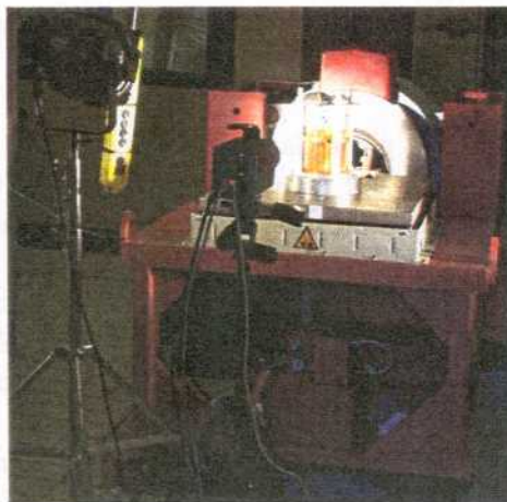
Principe d'essais de choc pour un problème couplé fluide/structure élémentaire avec surface libre fluide
