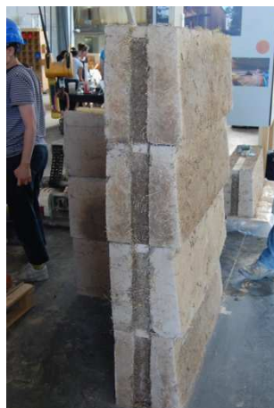
Figure I-17 : Empilement de blocs de bauge préfabriqués (Festival Grains d' Isère)
