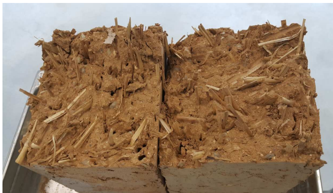
Figure III-18 : Surface de rupture d'un échantillon 14x14x56 cm avec 2 % de fibre
