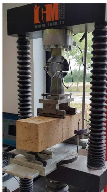
(b) L'essai flexion quatre points
