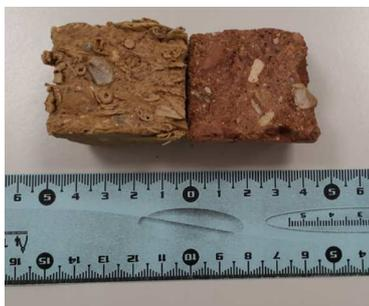
Figure II-30 : Echantillons de bauge pour essai sorption/désorption.
