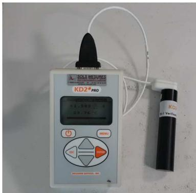
Figure II-24 : Mesure sur échantillon standard
