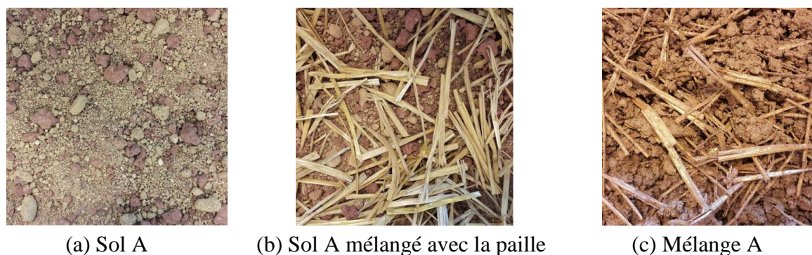
Figure II-14 : Etapes de préparation d'un mélange terre-fibre.
