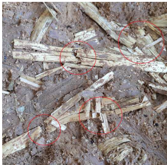
Figure III-23 : Rupture des fibres sous l'effet de traction dans la zone centrale des échantillons cylindriques
