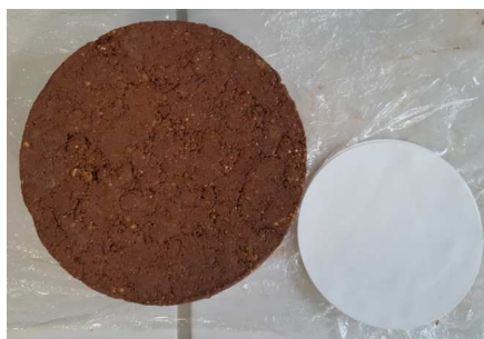
Figure II-27 : Mesure de la succion par papier-filtre
