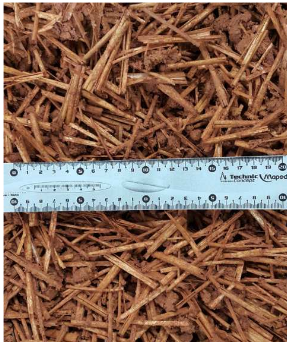
Figure IV-21 : Mélange terre-paille à l'état humide
