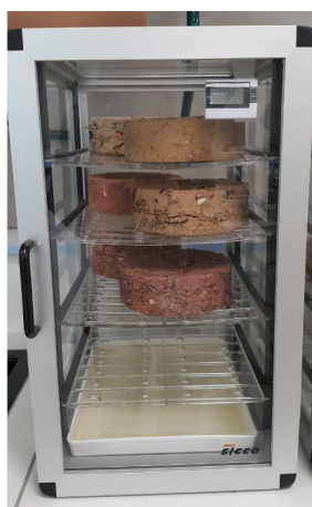
Figure II-28 : Dessiccateur avec solution saline saturée
