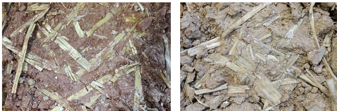
Figure III-24 : Rupture des fibres dans la zone centrale sous l'effet de traction des échantillons cubiques à W_{OPN}
