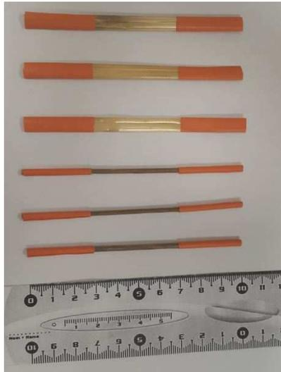
(a) Fibres utilisés pour l'essai de traction
