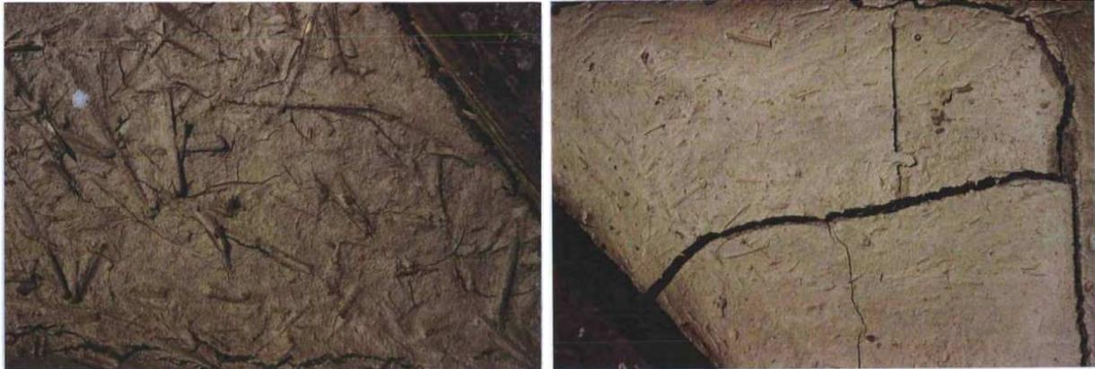
(a) Surface de la bauge renforcé par les fibres
