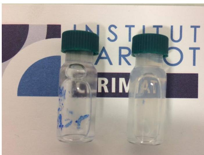
FIGURE 3.22 – A gauche, un gel greffé PNIPAM à température ambiante et, à droite, chauffé à 50 °C.
