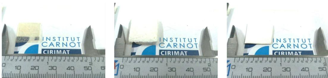
FIGURE 2.15 – Les trois différents matériaux obtenus : (gauche) Xéro séché par évaporation, (milieu) Lyoph séché par lyophilisation et (droite) un SCC-Mat passé au sécheur supercritique SCC.
