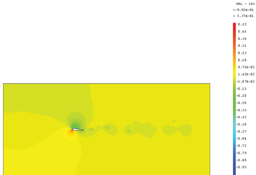
Fig. III.4 – Champ de pression dans le fluide à t^* = 4.2 . Cas 3.
