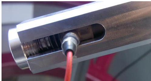
Figure 2-34 : Vue arrière de la chambre contenant le ressort, le capteur, et l'extrémité du guide d'onde
