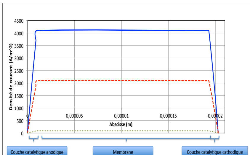
FIGURE IV.12 – Distribution de la densité de courant à l'AME pour J_0 = 90 A/m^2 [-], pour J_0 = 1575 A/m^2 [- -] et J_0 = 4785 A/m^2 [- .]
