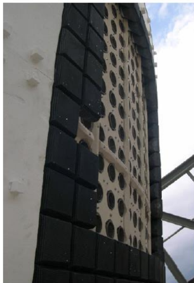
Figure 1.39 - Récepteur SOLAIR 3000 constitué de 270 modules carrés en SiC (structure nid d'abeilles) [CALIOT12].
