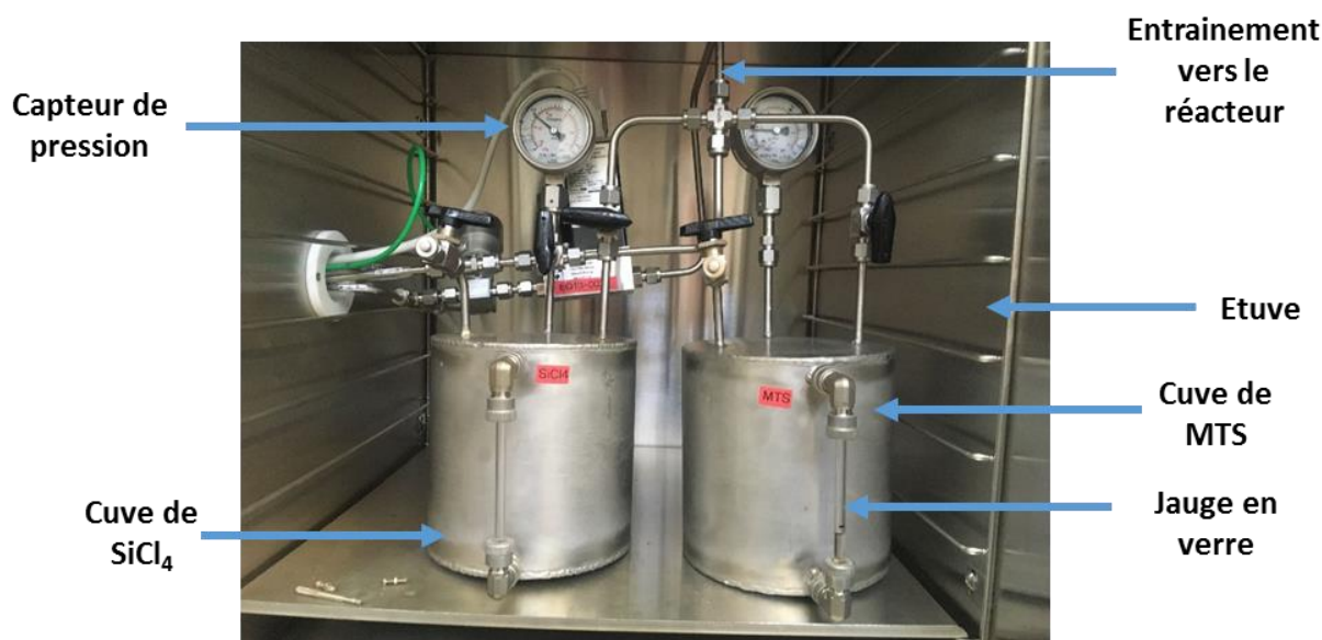
Figure 2.11 - Cuve de MTS et de \text{SiCl}_4 au sein de l'étuve.
