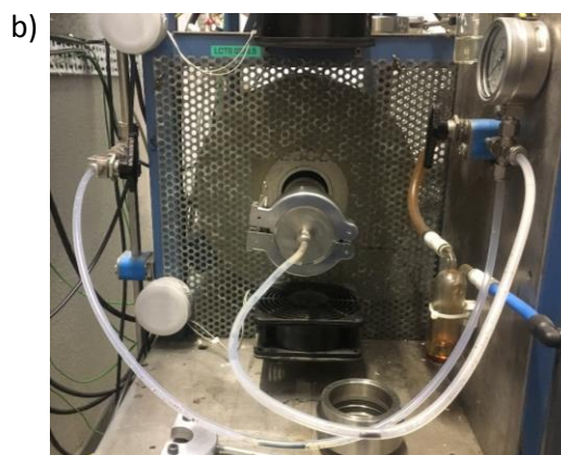
Figure 2.5 - (a) schéma légendé du four tubulaire de traitement thermique (la lettre « D » correspond à des débitmètres), (b) photographie selon l'angle de vision représenté par l'œil.
