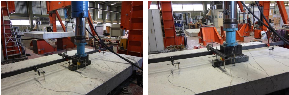
(a) Figure 3.1 : Banc d'essai de la dalle S2-Lplaque=60cm
