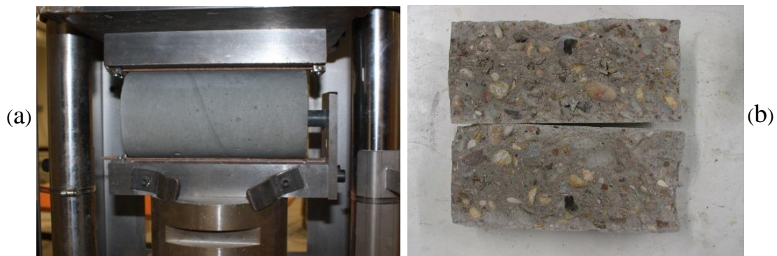
Figure 3.16: Essai de fendage ; a) Presse de fendage ; b) Plan de rupture de l'éprouvette
