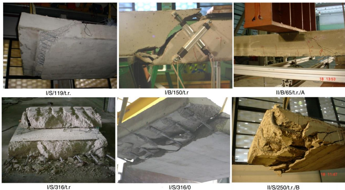
Figure 2.31 : Faciès de rupture des spécimens Gurutzeaga et al. 2015 [87]
