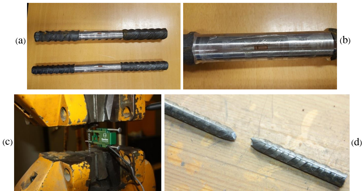
Figure 3.17 : Essai de traction directe sur acier : a) Barres HA20 et HA25 usinées et instrumentées; b) jauge de déformation sur une éprouvette HA25; c) Banc d'essai avec extensomètre ; d) Rupture
