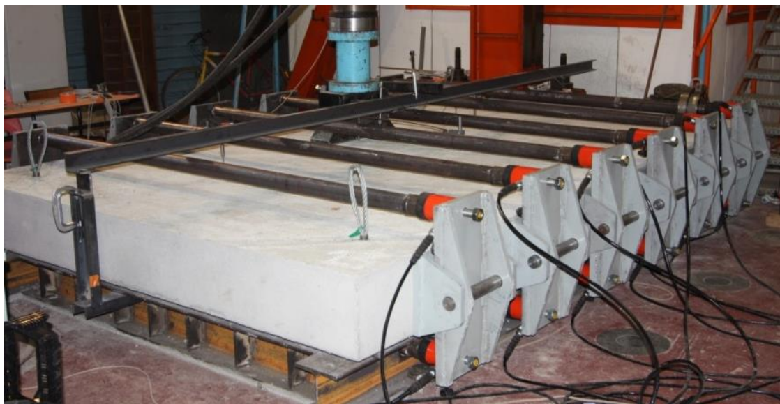
Figure 3.11 : Banc d'essai du chargement axial en traction
