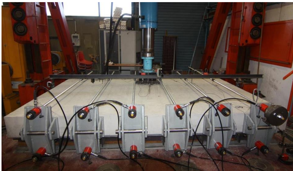
Figure 3.7 : Détail du dispositif de chargement axial en compression
