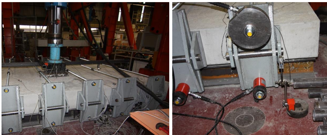
Figure 3.8 : Banc d'essai du chargement axial en compression
