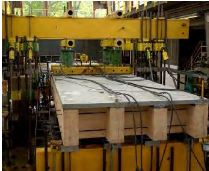
Figure 28 : Tablier d'un pont mixte bois/béton/composite testé au LCPC (d'après Ben Mekki et al. 2007)
