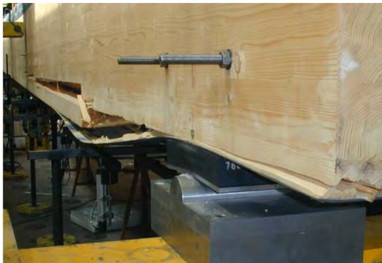
Figure 29 : Rupture de la poutre dans la zone tendue (d'après Ben Mekki et al. 2007)
