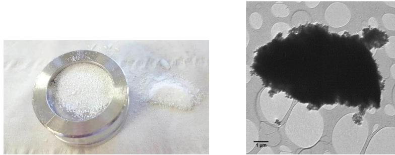
Figure IV. 24 : Poudre T365B non cohésive après un essai de compression œdométrique et photographie MET d'un grain de silice T365B d'environ 10 µm
