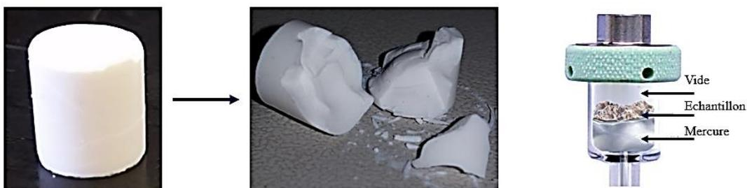
Figure II. 21 : Compacts 10 mm d'épaisseur et 9 mm de diamètre utilisés en porosimétrie mercure. A droite, la schématisation montre un pénétromètre en cours de remplissage.
