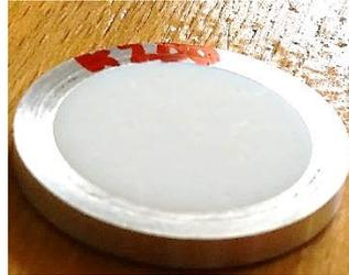
Figure II. 5 : : Pastille de silice K200 mise en forme après compression œdométrique
