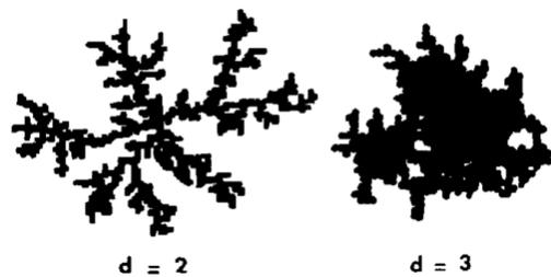
Figure I. 16 : Agrégats fractals de masse formés par agrégation de particules en régime limité par la diffusion (modèle de WITTEN-SANDERS). L'agrégat à gauche a été formé dans un espace de dimension  $d=2$ . La figure de droite est la projection sur un plan d'un agrégats formé dans un espace de dimension  $d=3$  (Legrand et al. 1990)
