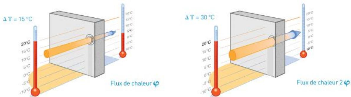
Figure 2 : Flux de chaleur à travers une paroi (ADEME 2015)
