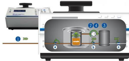
**Figure II. 14 : Pycnomètre Hélium (AccuPyc II 1340<sup>®</sup>) (micromeritics.fr) – 1) Le gaz inerte circule dans la chambre à échantillon – 2) L'équilibre est atteint – 3) Le gaz circule dans la seconde chambre pour mesurer le volume, la vanne b s'ouvre – 4) L'équilibre est à nouveau atteint**
