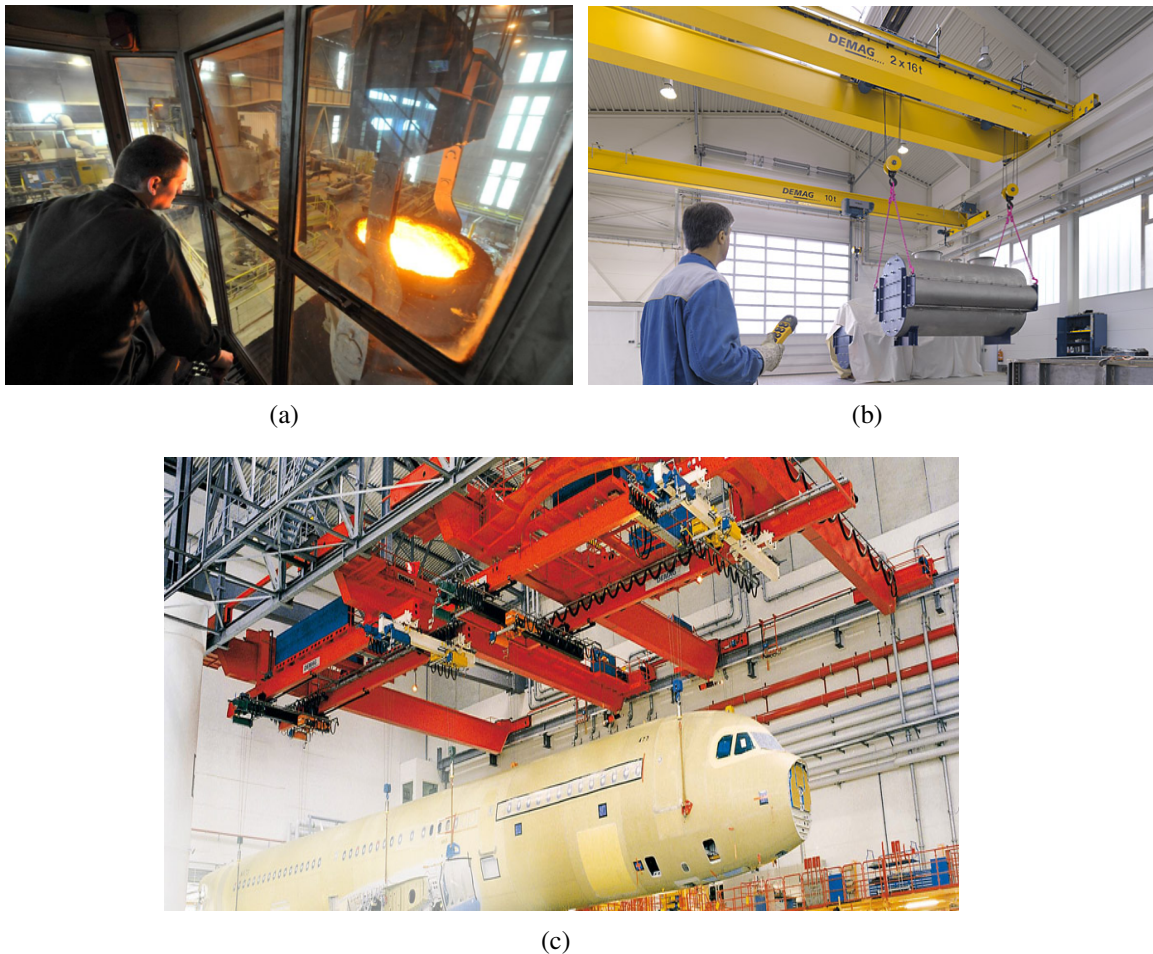
FIGURE 1.1 – Exemples de ponts roulants manipulant des charges
