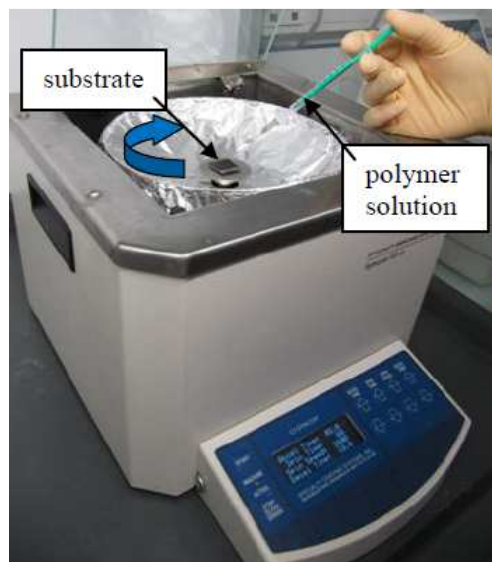
Figure 2.10 : Spin coater (Specialty Coating Systems, SCS) utilisé pour la fabrication des surfaces de polystyrène
