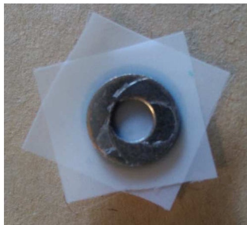
Figure 22 : Dispositif permettant de faire un masque sur un cristal à l'aide de tissu pour tamis.
