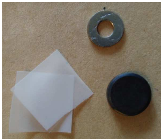
Figure 22 : Dispositif permettant de faire un masque sur un cristal à l'aide de tissu pour tamis.
