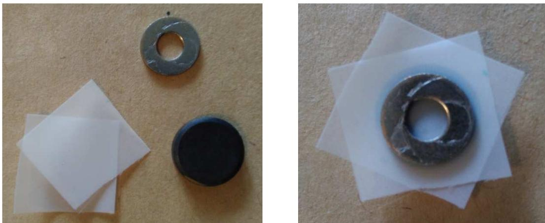
Figure 22 : Dispositif permettant de faire un masque sur un cristal à l'aide de tissu pour tamis.
