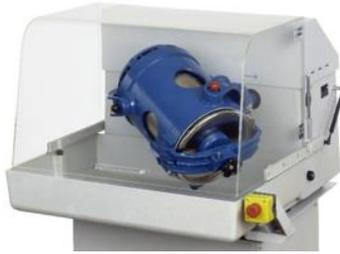
*Figure 4.4.b Mélangeur tridimensionnel Turbula*
