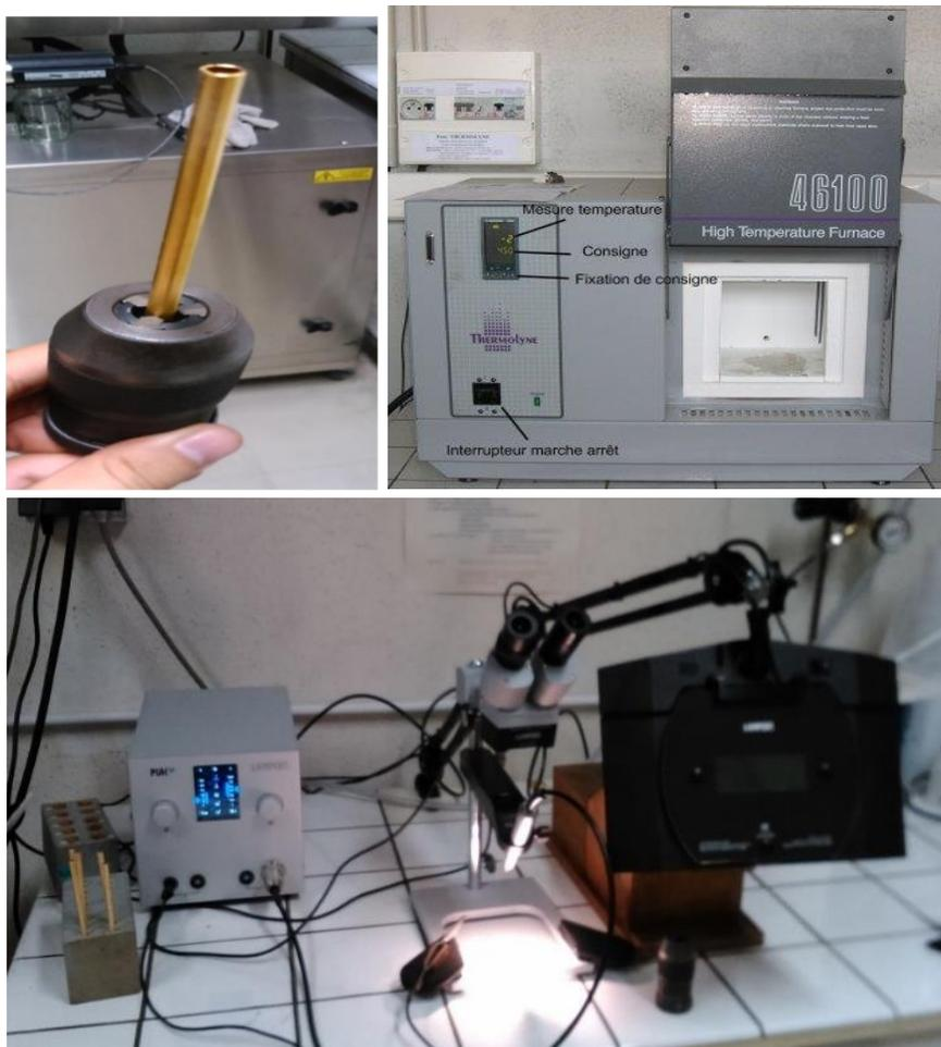
Figure 2- 3. Mandrin de sertissage, four à moufle (Thermolyne 46100) et Poste à souder (PUK-4, Lampert).
