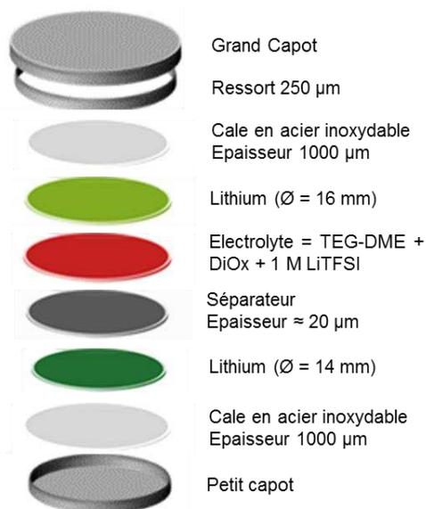
Figure 13 : Schéma de la configuration des piles bouton en surcharge pour poussée dendritique
