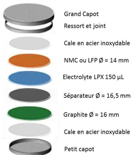
Figure 10 : Schéma de l'assemblage d'une pile bouton complète
