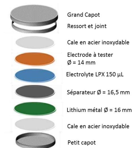
Figure 12 : Schéma de l'assemblage d'une demi-pile bouton
