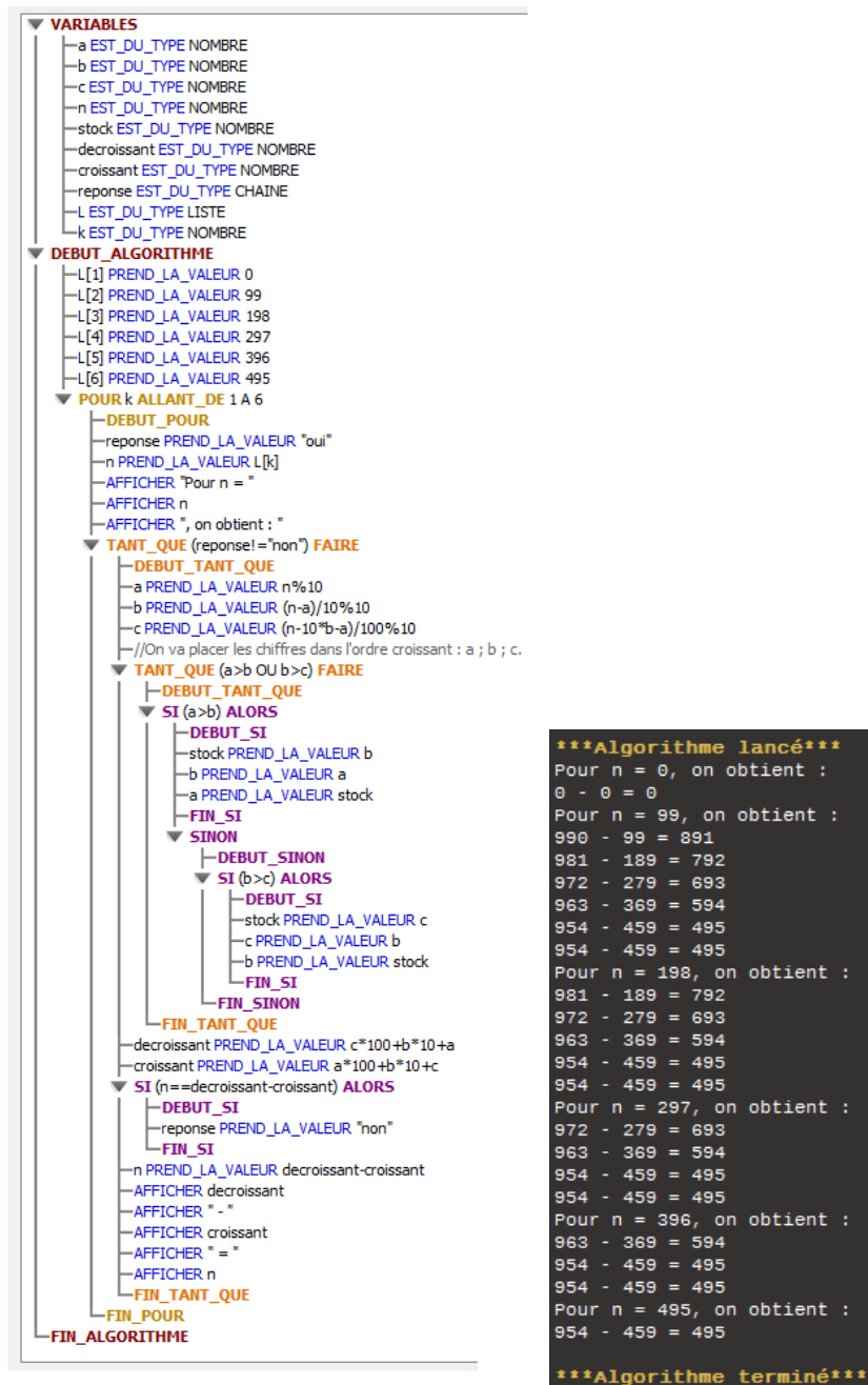
Figure 49 (Cas d'un algorithme Kaprekar « automatisé » sous Algobox avec utilisation d'une LISTE complétée avant l'itération sans référence aux multiples de 99)
