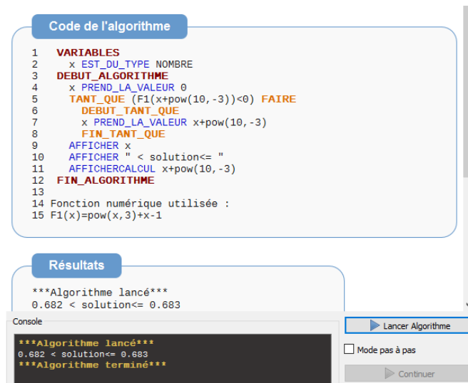
Figure 129 (Un algorithme sous AlgoBox avec une structure « TantQue »)
