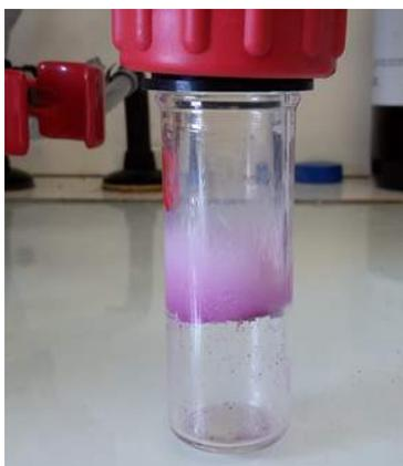
**Figure II.31** – Photo du dépôt d'un film du complexe  $[\text{Fe}(\text{HB}(\text{tz})_3)_2]$  dans l'appareil de sublimation obtenu à  $290^\circ\text{C}$  avec un vide de  $10^{-5}$  mbar.
