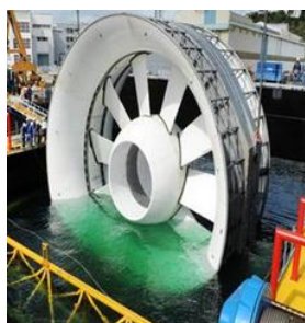
Figure 1.14 – Turbine à entraînement circconférentiel développée par Open hydro
