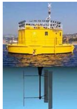
Figure 1.13 – Turbine à axe vertical type Kobolt, projet Enermar
