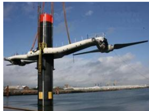
Figure 1.7 – Projet Seagen, hydrolienne bipale à double hélice et à axe horizontal développée par MCT Ltd
