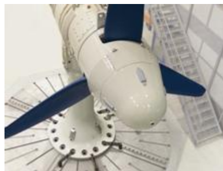
Figure 1.11 – Hydrolienne tripale à axe horizontal développée par Voith-GDF
