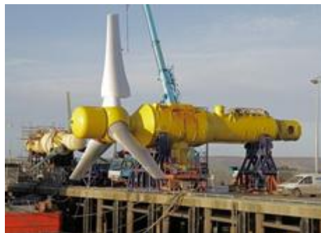
Figure 1.9 – Hydrolienne tripale à axe horizontal développée par Alstom
