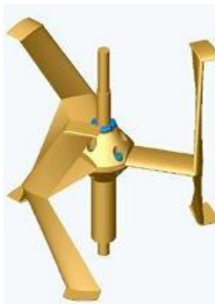
Figure 1.12 – Turbine à axe vertical type Achard, projet Harvest
