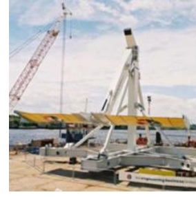
Figure 1.19 – Turbine à pale oscillante du projet Stingray
