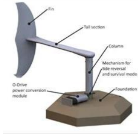
Figure 1.17 – Turbine à pale oscillante autour d'un axe vertical développée par BioPower
