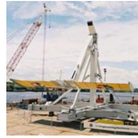
Figure 1.19 – Turbine à pale oscillante du projet Stingray
