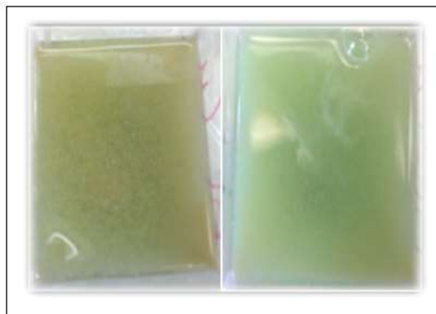
Figure A. 1: Dépôt observé après production d'hydrogène
