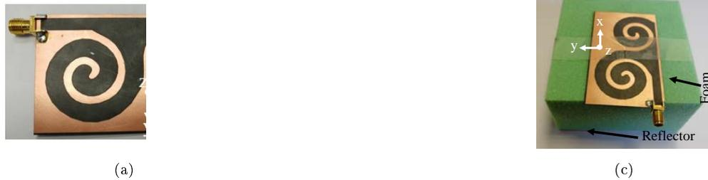
Figure vi: Prototype. (a) Vue de dessus, (b) vue de dessous (c) Antenne sur réflecteur métallique.
