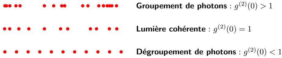
**Figure I.4.3** – Comparaison des temps d’arrivée des photons mesurés sur les détecteurs dans le cas d’un groupement de photons, de la lumière cohérente et d’un dégroupement de photons, de haut en bas.
