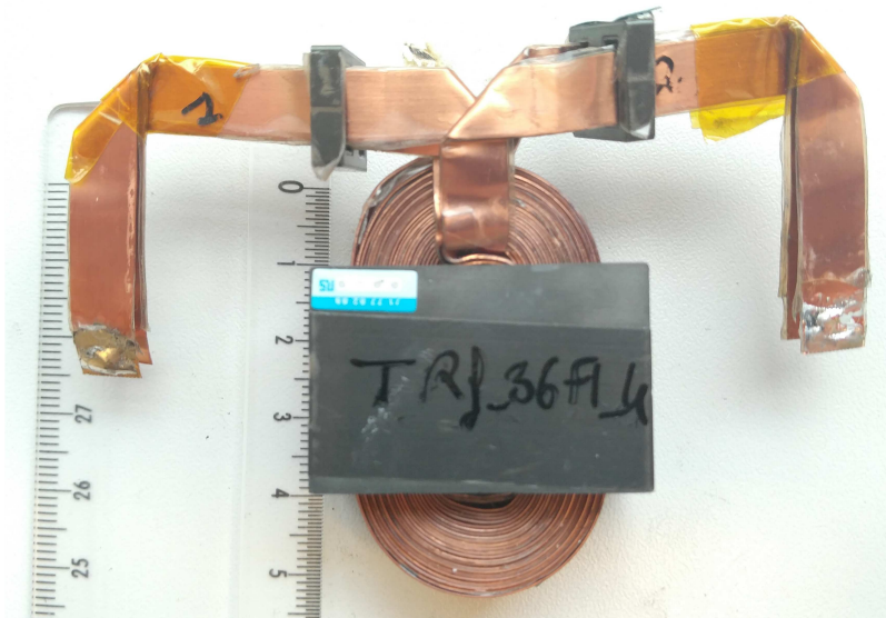
FIGURE 3.69 – Transformateur Trf_{36F14} avec deux inductances supplémentaires
