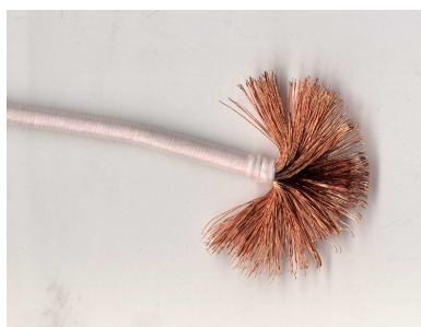
FIGURE 3.3 – Bobinage en fil de Litz
