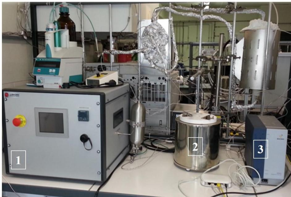
**Figure 3. 1: Montage du test catalytique en reformage à sec du méthane utilisé**
