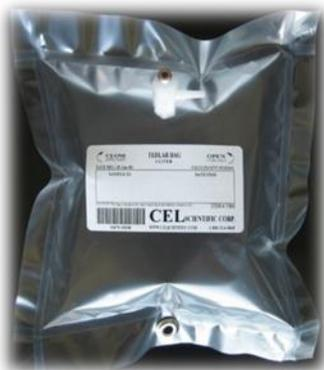
Une analyse directe à partir des sacs Tedlar a été effectuée pour les composés majoritaires. Dans ce cas, chaque sac rempli d'échantillon, a été connecté directement à la boucle d'injection de la chromatographie en phase gazeuse par un tube.
