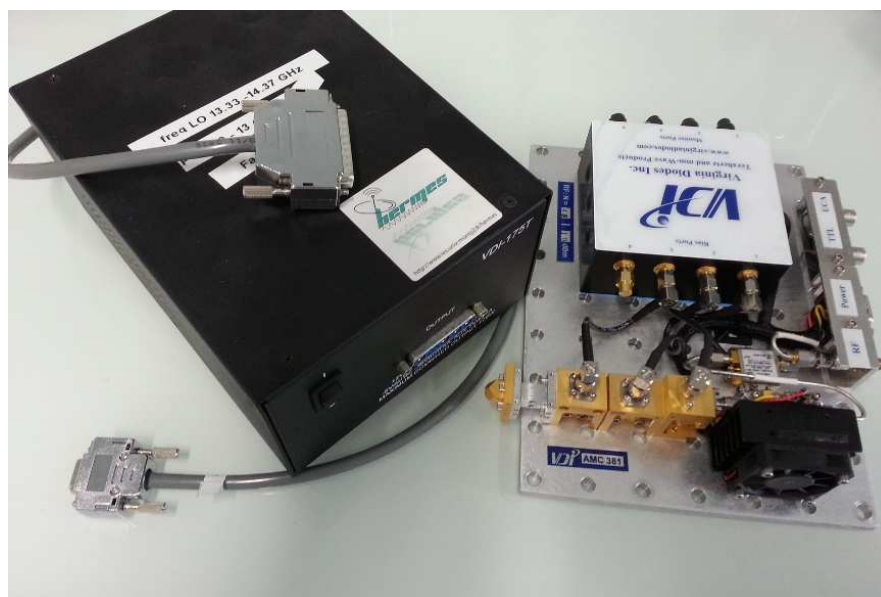
Figure B - 3 : Source THz VDI-AMC-381 avec son boîtier noir d'alimentation électrique.
