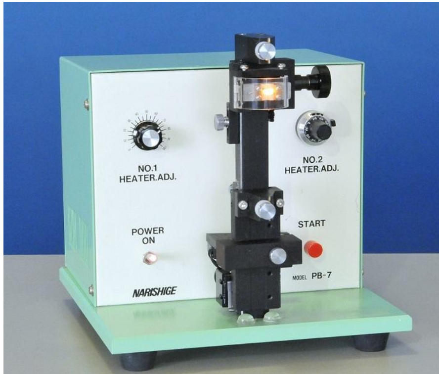
Figure 43: étireuse de capillaire (Narishige, PB7)
